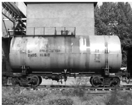
图4 车厢上的油罐
